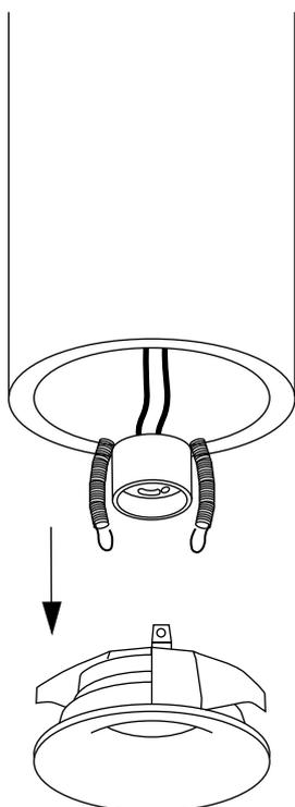
**4** Зафиксируйте LED лампу в патроне, сцепите пружины с вставкой и установите вставку с лампой обратно в светильник.
